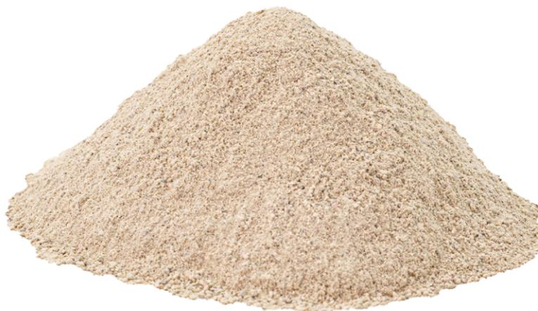
La **BENTONITA CÁLCICA** mineral de la familia de los aluminosilicatos posee una gran propiedad de hinchamiento al estar en contacto con agua por su estructura laminar.
